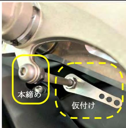
ブレーキペダルのネジ部に丸キャップボルト M6×50 を締め込み、裏から左図のように、M6 ナットで本締めし完全に固定します。
