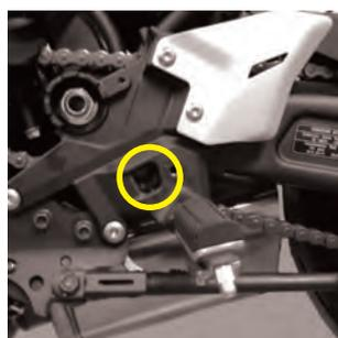
●②ボルトはシフトペダルを取り外すと肉抜き穴から取り外せます。
