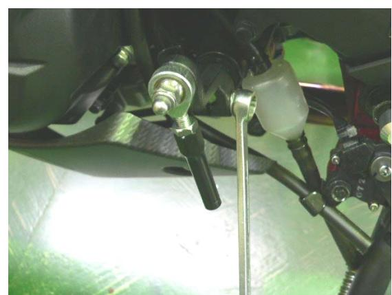
H/B チェンジ側ステップホルダーをメインホルダーに取付け、皿キャップボルト M8×20 で仮締めします。
