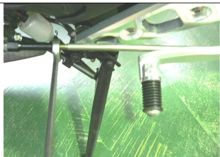
H/B チェンジカム側ステンレスロッド・ペダルカム側ピロボールに、アルミチェンジロッドのネジ部を1~2山程をかけます。
