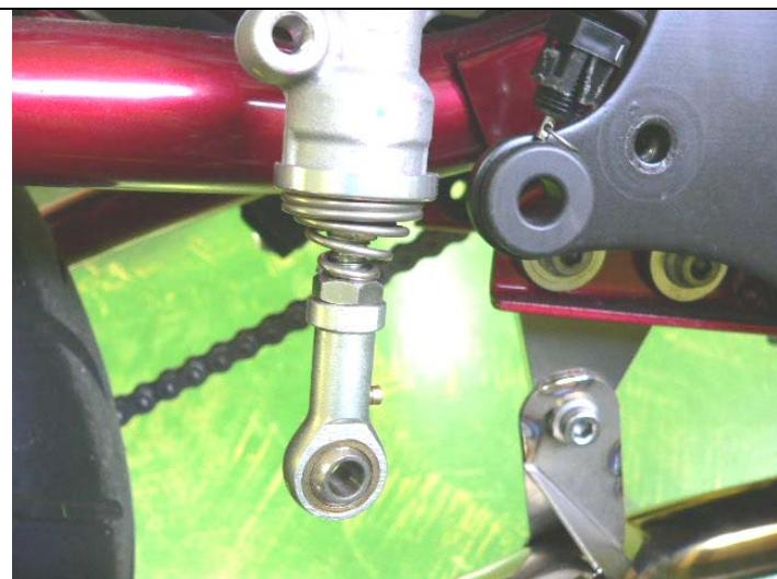
先程取付けた部品を取り付けたリアブレーキマスターシリンダーを、H/B ステップホルダーの裏側から取り付け、付属の丸キャップボルト M8×20 を、ステップホルダーの表側から  $\phi 8.5 \text{ mm}$  穴に通し、リアブレーキマスターの M8 ネジに仮締めする。
