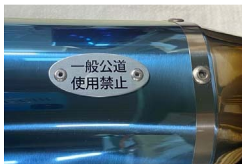
サイレンサー裏側の 「一般公道使用禁止」のプレートが目印
