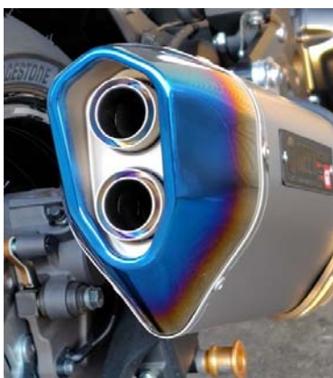
新型サイレンサー出口
