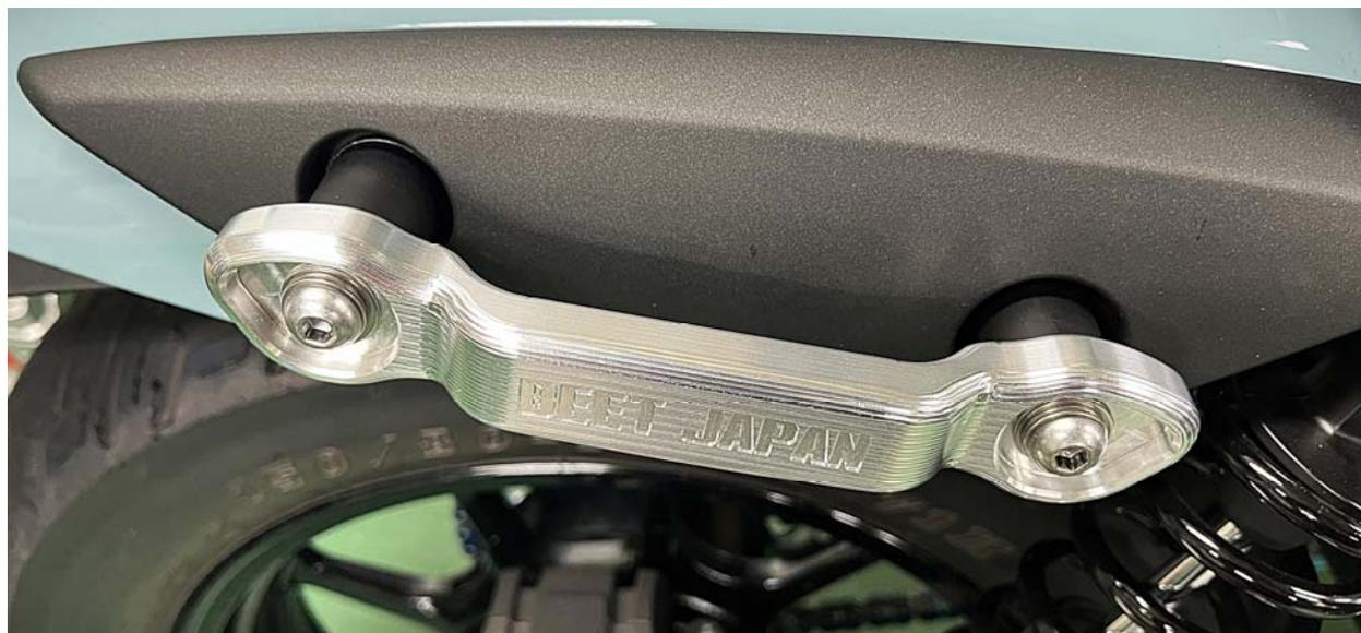
アルミ削り出し クリアアルマイト仕上げ（左右共通） セット商品は片側分です
