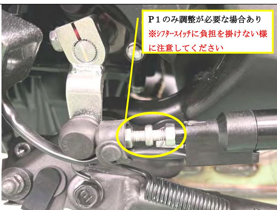
停車状態で、シフトチェンジ操作を 2~3 度行って、シフトチェンジ操作に不具合が無いか確認して下さい。
