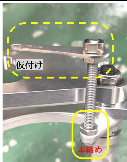
ブレーキペダルのネジ部に丸キャップボルト M6×60 を締め込み、裏から左図のように、M 6 ナットで本締めし完全に固定します。
