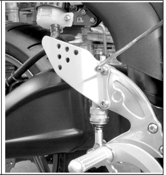
そして、ブレーキペダルの角度が合わない場合は、ピロボール先端のM8 ボルトをブレーキカムから取り外して、ピロボール自体を回転させて調整します。
