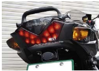
テールランプ 及びウインカー点灯状態
