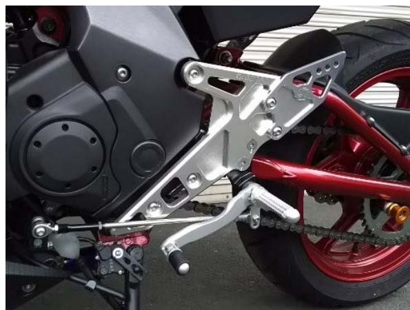
Evolution マフラー用サイレンサーステー + ヒールガードSET 装着状態
