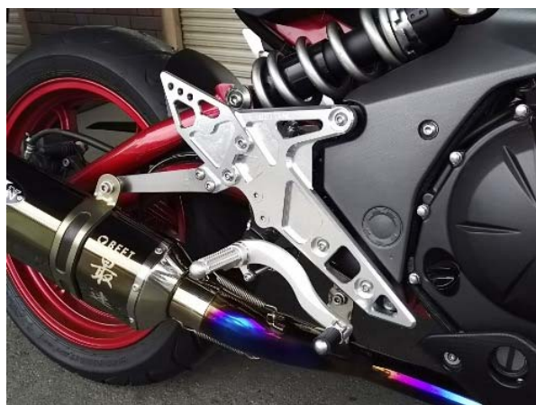
Evolution マフラー用サイレンサーステー + ヒールガードSET 装着状態
