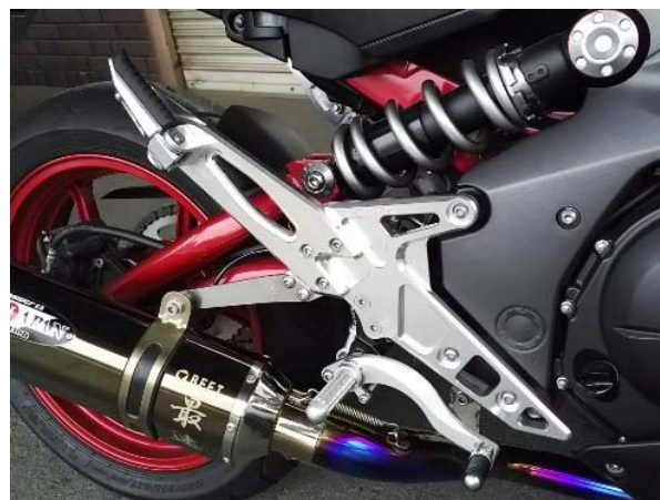
Evolution マフラー用サイレンサーステー + タンデムキット 装着状態
