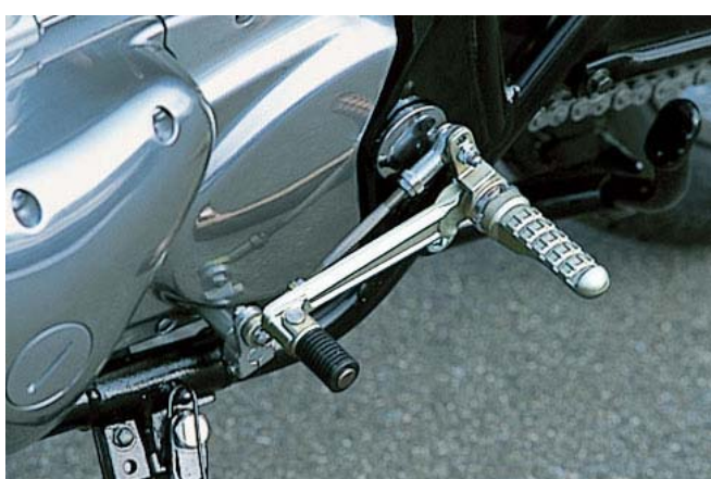
画像は旧型のステップダイとペダルの形状です
