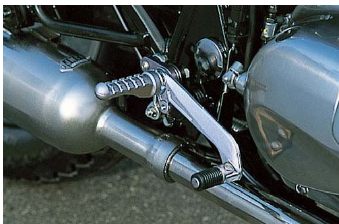
画像は旧型のステップダイとペダルの形状です
